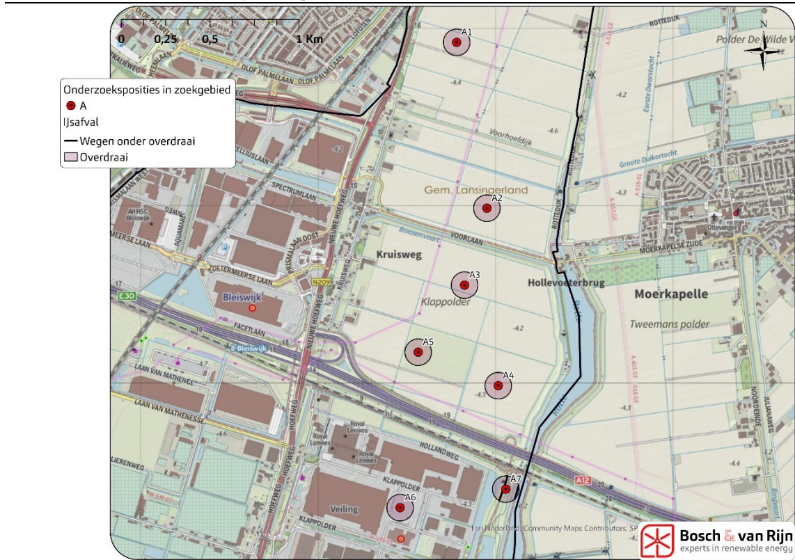
Figuur 43 Wegen waar mogelijk ijsafworp op kan treden onder de overdraaicirkels van de windmolens van onderzoeksofstelling A.
